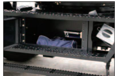
La machine est dotée d'un coffre à outils suffisamment spacieux pour ranger une caisse à outils. Le coffre peut être utilisé comme espace polyvalent de rangement d'outils et de pistolets de graissage.
