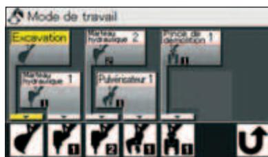
Quand on change d'outil, le réglage du débit d'huile peut être réalisé automatiquement par sélection du mode de travail sur le moniteur LCD. Des ajustements mineurs du débit d'huile sont possibles si besoin est.
