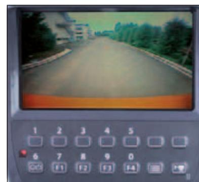
Le grand écran couleur LCD, combiné à la rétro-caméra sur le contrepois, fournit une vue pratique de la zone à l'arrière de l'engin. La caméra arrière fonctionne automatiquement en marche arrière et elle peut être activée manuellement à l'aide d'un sélecteur sur le moniteur.
