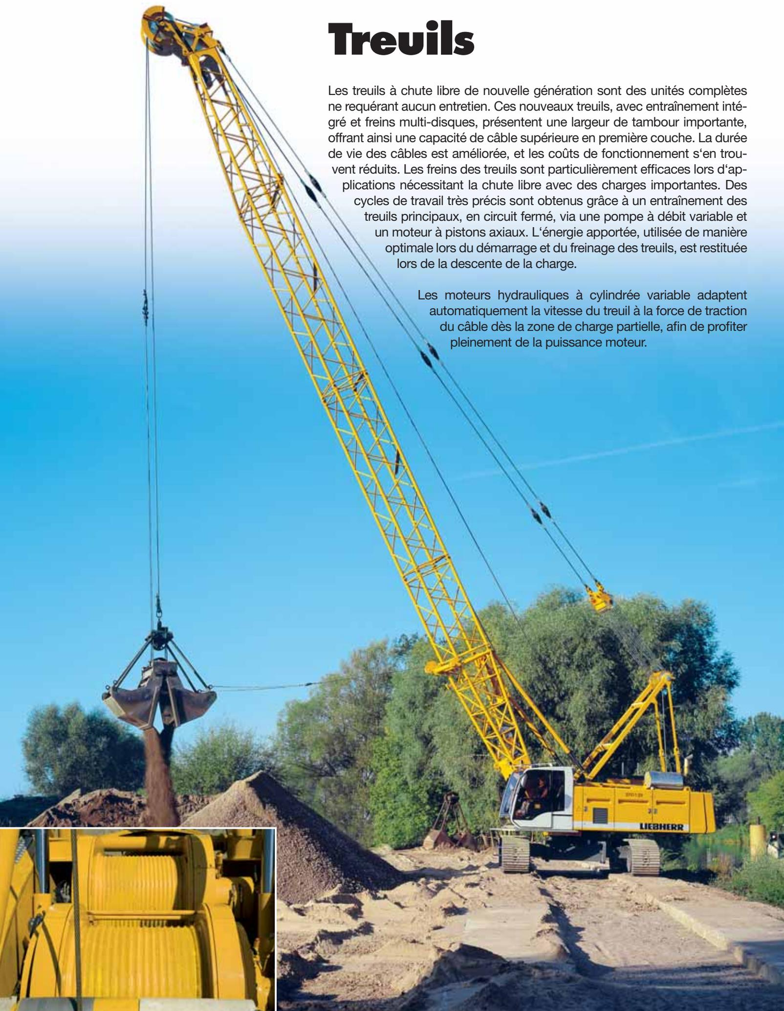
Pour l'application dragline, la commande Interlock libère automatiquement le câble de tirage pendant le levage du godet, et réduit ainsi considérablement la consommation de carburant. Le treuil de stabilisation est utilisé comme treuil de traction constante en chute libre. Cela permet un travail très efficace lors d'applications avec un grappin, une benne ou une boule de démolition.
