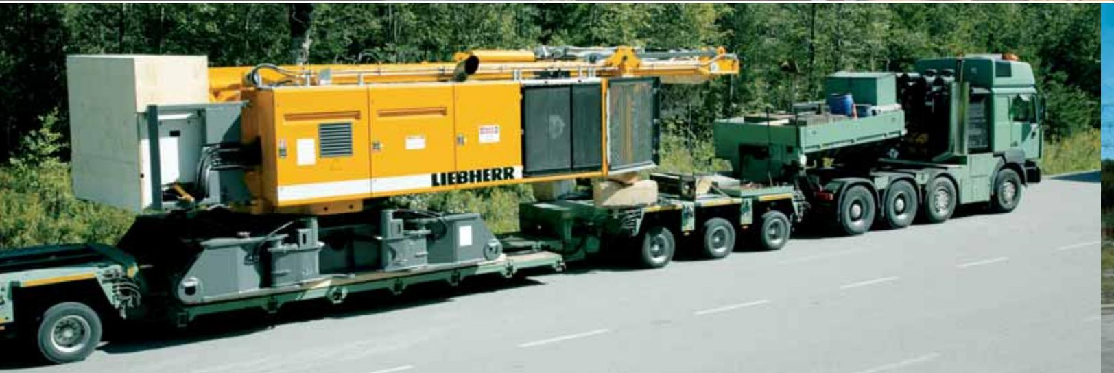
Afin d'optimiser l'encombrement, les éléments de la fléchette peuvent même être calés dans les éléments de la flèche principale. En raison de leur faible hauteur, les plaques de contre-poids sont placées sous les éléments de flèche. Les haubans et les axes sont quant à eux déposés dans les supports prévus à cet effet.
